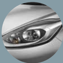
FAROS DELANTEROS Sistema de luces diurnas LED.
