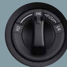
4X4 Función Shift-on-the-Fly para la caja reductora
