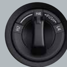
4X4 Función Shift-on-the-Fly para la caja reductora
